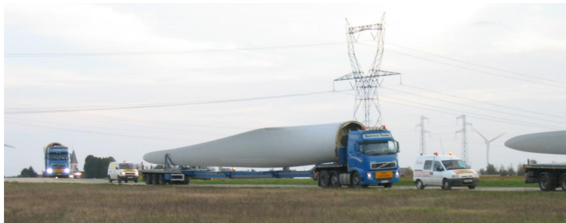
Figure 238 : Illustration du transport des pales (©ATER Environnement)
