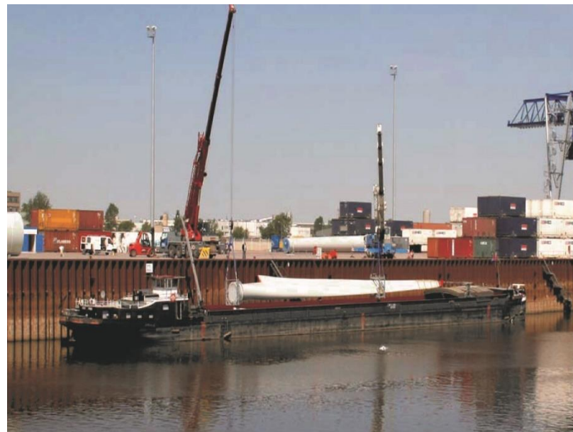
Figure 239 : Acheminement d'une pale par bateau (©ATER Environnement)
