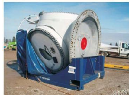
Figure 228 : Stockage d'un moyeu sur une plate-forme (source : EDF Renewelables, 2017)
